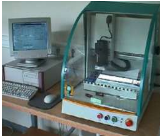
Micro fraiseuse Charlyrobot piloté par un ordinateur avec le logiciel Charlygraal
